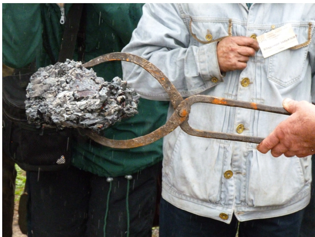
Рис.2 Самый большой кусок выплавленной крицы.
